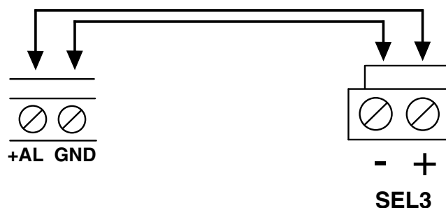
□ Fig. 9.1. Collegamenti per l'alimentazione di dispositivi tipo SEL26F (sirene autoalimentate)
